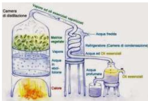
senziali dai tessuti vegetali di foglie, rami, corteccia e legna. Si applica con l'impiego di un distillatore, un dispositivo a tenuta stagna connesso a un generatore di vapore e a una serpentina di raffreddamento. Il distillatore, grazie alla serpentina di raffreddamento, riesce a separare le sostanze volatili dalle restanti componenti liquide.
